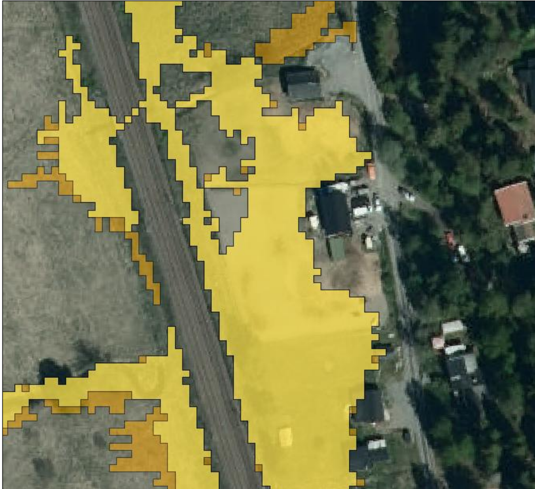
Figur 28. Byggnaderna lokaliserade på fastigheterna Vrå 1:199 och Vrå 1:198. I gult visas vattenutbredningen vid ett 50-årsflöde med Mannings tal = 15 \text{ m}^{1/3}/\text{s} i vattendragsfåran och i orange visas vattenutbredningen vid ett 50-årsflöde med Mannings tal = 5 \text{ m}^{1/3}/\text{s} i vattendragsfåran.
