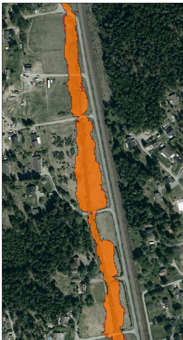
Figur 17. Översvämningsarna i de norra delarna av Pingla ström. I orange visas vattenutbredningen vid ett 50-årsflöde och i rött visas vattenutbredningen vid ett 100-årsflöde. Skillnaden mellan vattenutbredningen vid 50- respektive 100-årsflödet är liten.
