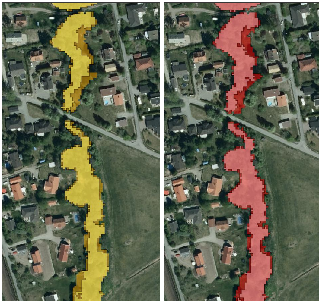
Figur 25. I bilden till vänster visas översvämningsutbredningen vid Q_{50} klimat med Mannings tal = 15 \text{ m}^{1/3}/\text{s} i vattendragsfåran i gult och med Mannings tal = 5 \text{ m}^{1/3}/\text{s} i vattendragsfåran i orange. I bilden till höger visas översvämningsutbredningen vid Q_{100} klimat med Mannings tal = 15 \text{ m}^{1/3}/\text{s} i vattendragsfåran i rosa och med Mannings tal = 5 \text{ m}^{1/3}/\text{s} i vattendragsfåran i rött. Ett högre Mannings tal i vattendragsfåran leder till lägre beräknade vattennivåer och således mindre vattenutbredning.
