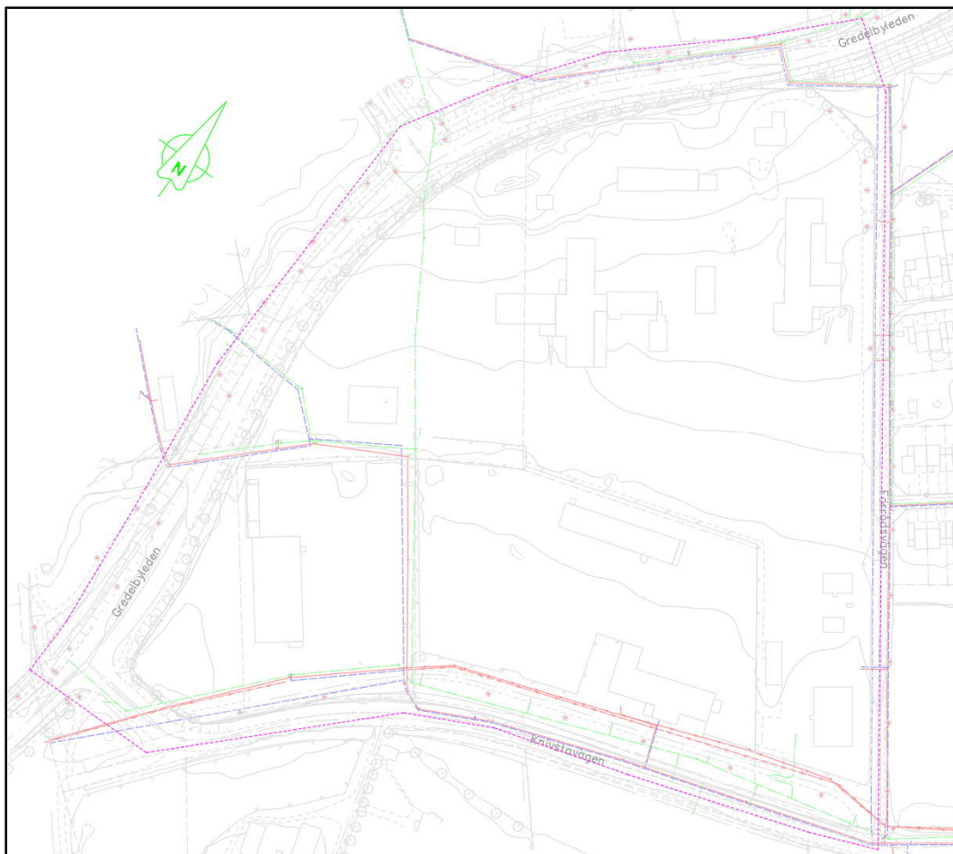
Figur 3. Befintliga VA-ledningar inom detaljplanområdet. Lila linje redovisar ungefärligt detaljplanegränsen, grön linje – dagvatten, röd linje – spillvatten och blå linje – vatten.
